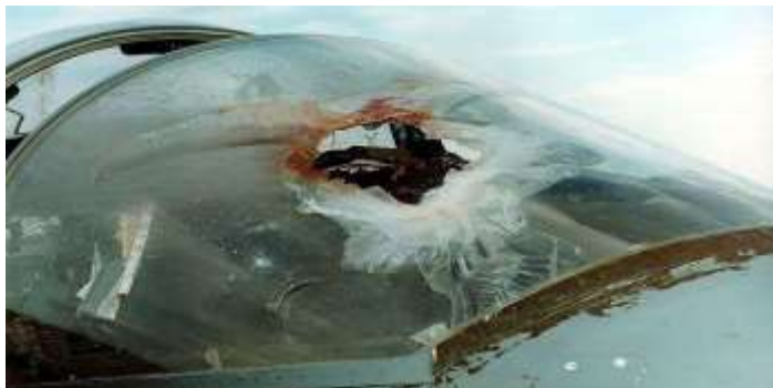
Рис. 2. Повреждение остекления штурмовика Харриер в результате ССП.
