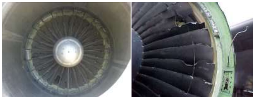
Рис. 1. Разрушение лопаток компрессора при попадании птиц.
