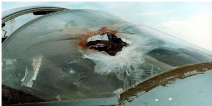
Рис. 2. Повреждение остекления штурмовика Харриер в результате ССП.
