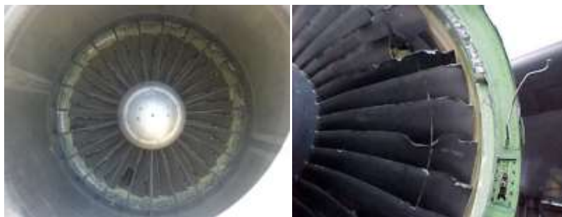
Рис. 1. Разрушение лопаток компрессора при попадании птиц.
